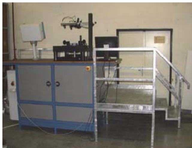
Optikai alakváltozás mérő rendszerrel felszerelt komplex lemezvizsgáló berendezés
