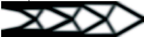
2. ábra. SIMP megoldása (TD: 160x40)
