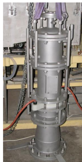
1. ábra. Bűvár üzemű víz alatti plazma berendezés MEROX TM lúg merkaptán tartalmának bontására (G.I.C. Kft. (2007))
