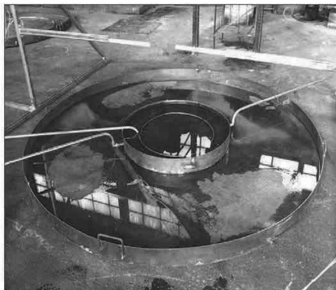
7. ábra: 2 m átmérőjű tesztmedence, jól látható az üzemanyag-betápláló mechanizmus
