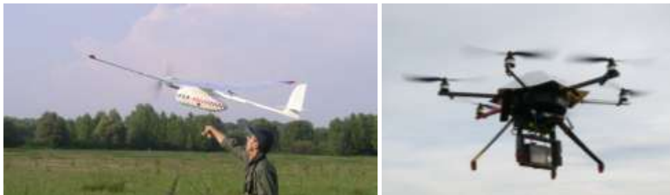
5. ábra Merevszárnyú UAV (Fenix) indítása és helikopter (Bee) lebegése. Mindkettő horvát gyártmány (6DOF), Magyarországon az R-Fire Kft. alkalmazza. Forrás: 6DOF és a szerző magánarchívuma
