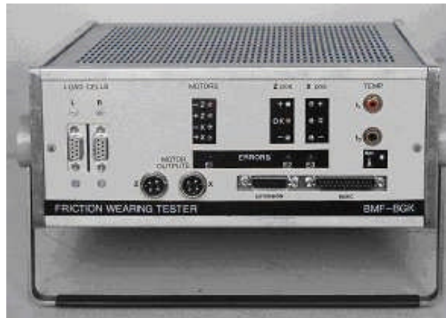
1.4. ábra. A külső vezérlőegység előlapja a mechanikai rendszer felőli illesztések csatlakozóival és a legfontosabb üzemállapotokat indikáló LED-ekkel
