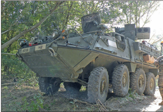
2. ábra. M1134-es irányított páncéltörőrakéta-hordozó, a kép jobb oldalán jól látható a toronyra szerelt TOW-2-es rakéták kettős indító berendezése
