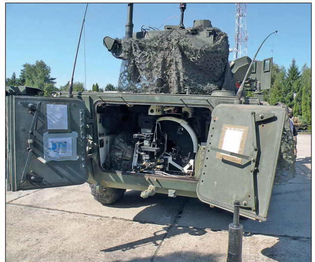
12. ábra. M1128-as tűztámogató hátsó nyílásai nyitott helyzetben, a nagy méretű ajtók segítik a lövések gyors be- és kiszállását, a muníció könnyebb bemálházását
