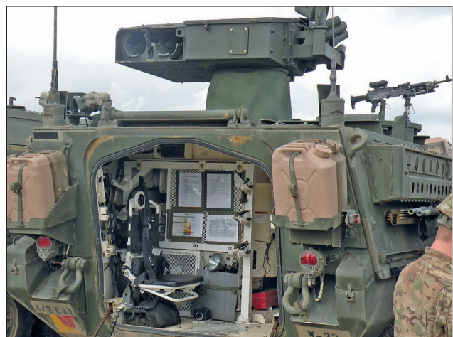
6. ábra. M1134-es irányított páncéltörő rakéta-hordozó lehajtott hátsó rámpával. Jól látható a küzdőtér egy része, és a torony bal oldalán a TOW-2-es rakéták indítócsövei
