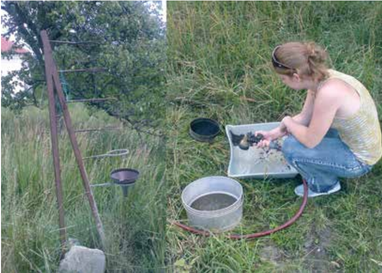
24. ábra. A nedves szításhoz szükséges szitasorozatot tartó állvány, valamint a szítálás egy mozzanata terepi körülmények között
