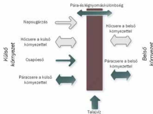
1. ábra: Határolószerkezetet érő hő- és nedvességhatások [6]
