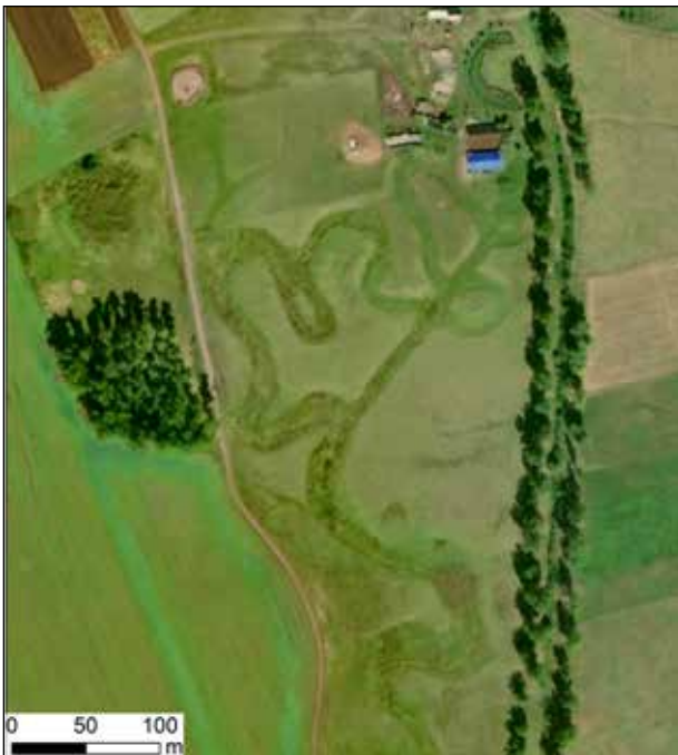
6. kép. A Lator-patak egykori, meanderező medre egy korábbi szabályozás eredményeként levágott kanyarulatokkal, és a mai, teljesen egyenes, mesterséges meder Mezőkeresztestől nyugatra
