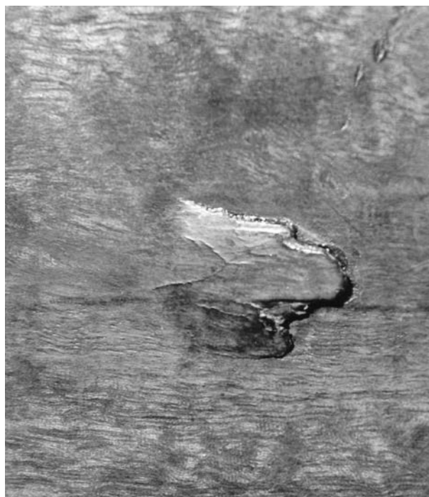
3. A váz összeszáradt, a tipli kinyomta az oldalfal furnérját
