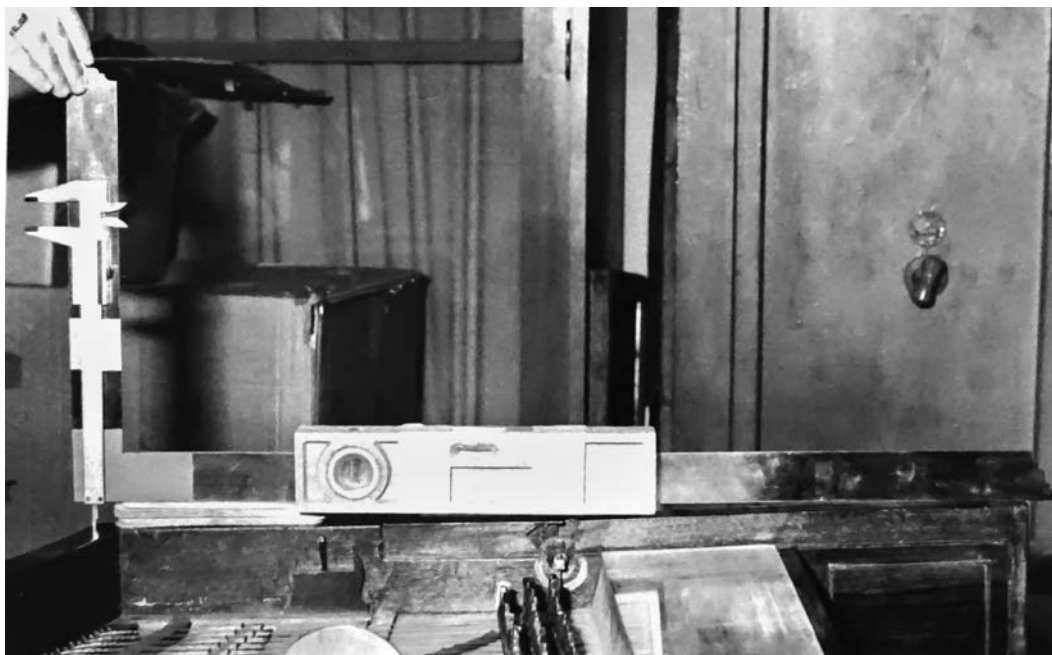
1. A húrok húzóereje miatt a rövid oldal megsüllyedt. A rövid oldal deformációjának mérése
