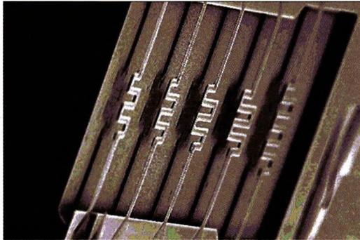
2. ábra. A mikrofűtőtestet alkotó egykristályos szilícium meanderek egy-egy Pt szállal kontaktálva >80  $\mu\text{m}$  mély árok felett termikusan szigetelten működtethetők. A katalitikus égetéshez elengedhetetlen >450 °C hőmérséklet eléréséhez szükséges fűtőteljesítmény a 100  $\mu\text{m}$  nagyságrendű eszközben így a minimális 20–25 mW-ra csökken
