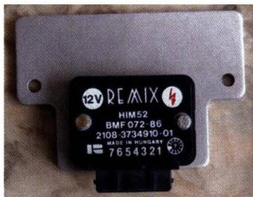
2. ábra. Ez, a vastagréteg hibrid áramkörös gyújtómodul, nemcsak a reménybeli LADA együttműködés, hanem a TELEFUNKEN - REMIX joint - venture megalapozója volt, az utóbbinál teljes sikerrel
