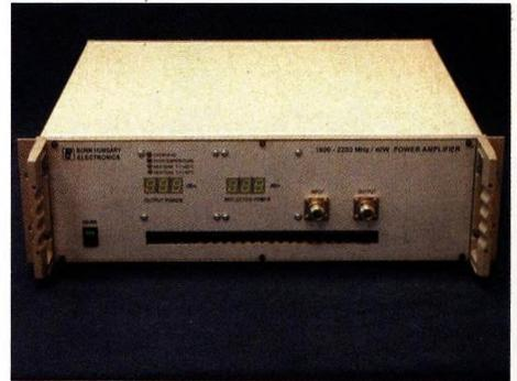
6. ábra. A kiszajú erősítők mellett másik irányvonal a nagy teljesítmény: integrált hűtőrendszerrel ellátott rack-kompatibilis 2 GHz-es, 40 W kimenő teljesítményű, folyamatos üzemű félvezető erősítő, amelynek a 200 W-os változata is elkészült
