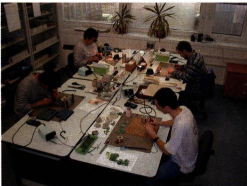
1. ábra. A kis sorozatú és kísérleti gyártás kézi szerelése (nagyobb sorozatok SMD beültető gépsoron, alvállalkozásban készülnek)
