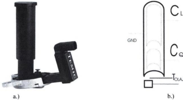
21. ábra. **TEMIC QLT** olajszenzor és vázlata: az a.) ábra baloldali része egy kettős koaxiális kondenzátor, amelyet a b.) ábra vázol fel. Az a.) ábrán a jobboldali részében helyezkedik el az elektronika és a csatlakozóalj.
