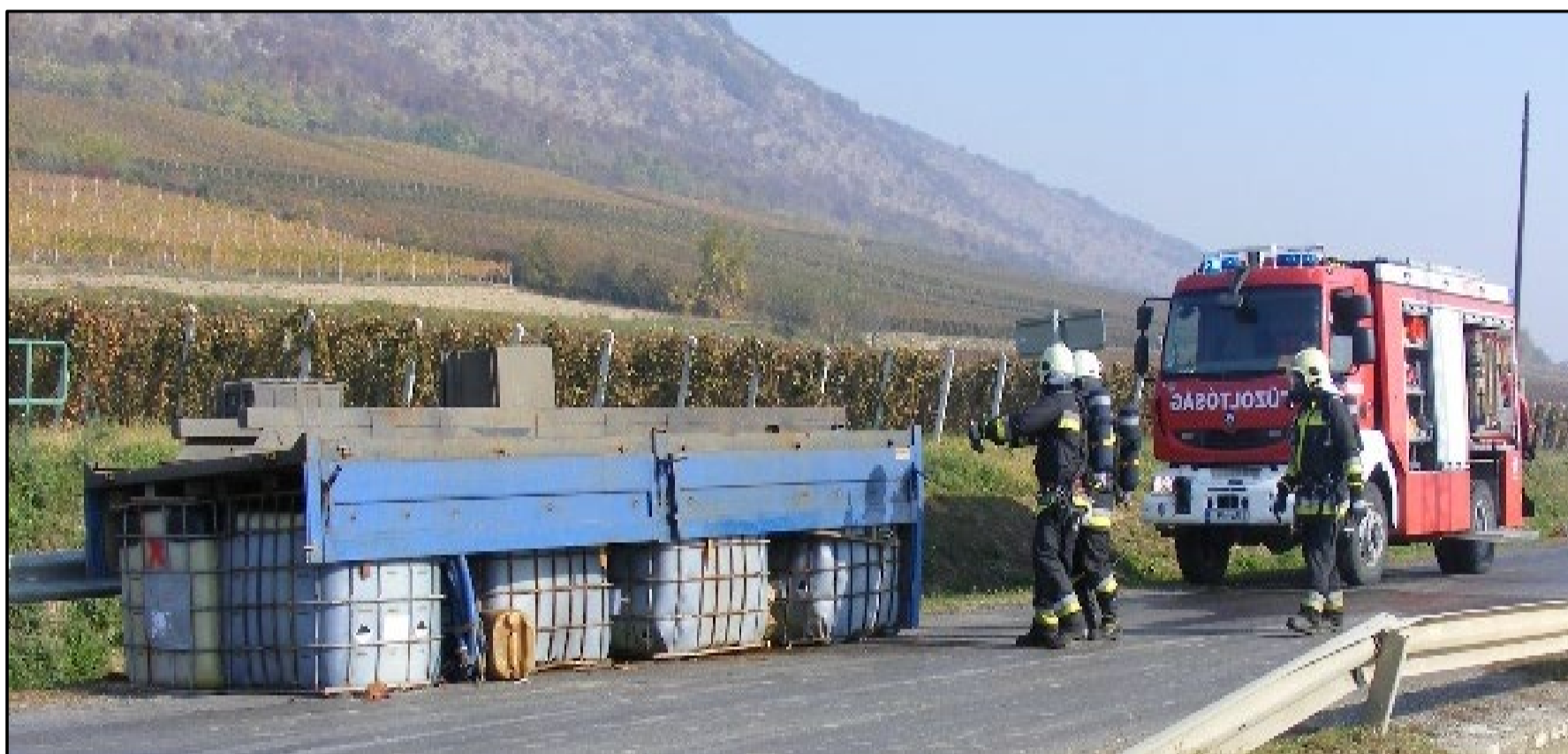
1. számú fotó: ADR szállítmány leszakadt felépítménye. Forrás: 126
