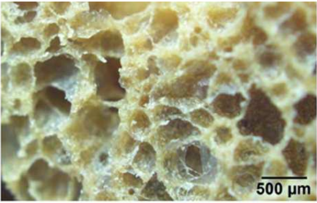
5. ábra: Az elkészített gumihabok kereszt-metszeti felvételei
