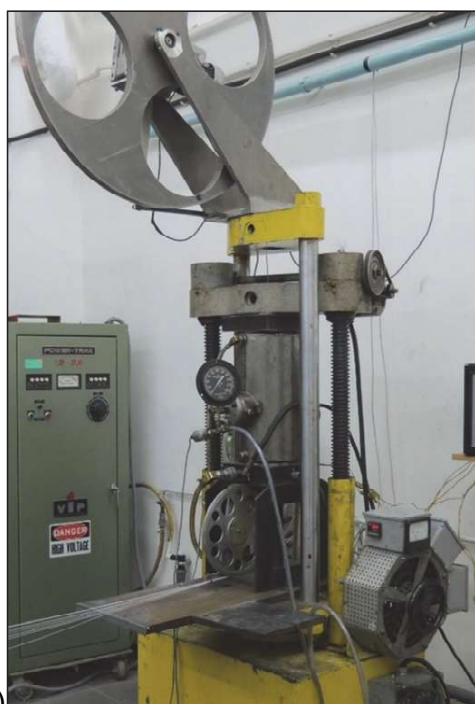
7. ábra – a) A szálerősítéses alumíniumhuzalok folyamatos gyártására alkalmas Blücher-kemence vázlata [25], b) Blücher József a bostoni NEU-n működő laboratóriumában az ezredfordulón, vállán a világon egyedülálló termékkel, a kerámiaszál-erősítésű alumíniumhuzallal, c-d) a kerámiaszál-kötegek bevezetésével folyó gyártás 2013-ban, a BME ATT-n
