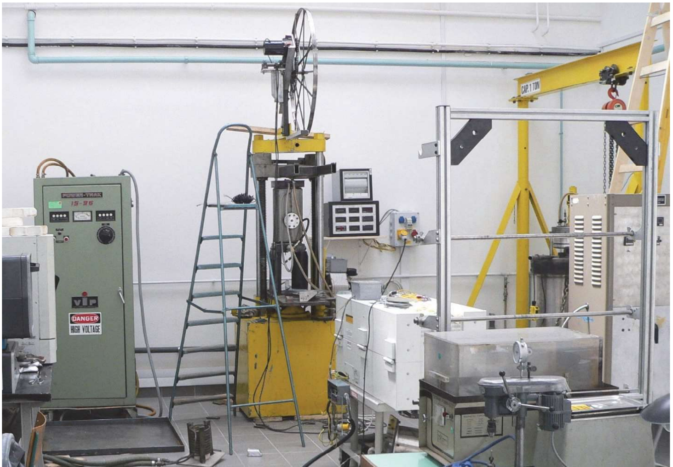
5. ábra – A Bostonból Budapestre került kemencék 2005-ben, a laboratórium berendezésekor; a Blücher-kemencék acélszerkezete sárga színű. A vákuumozható, nyomásos besajtolókemence a képen jobbra, hátul található. A kép középső részét tölti ki a folyamatos huzalgyártó kemence
