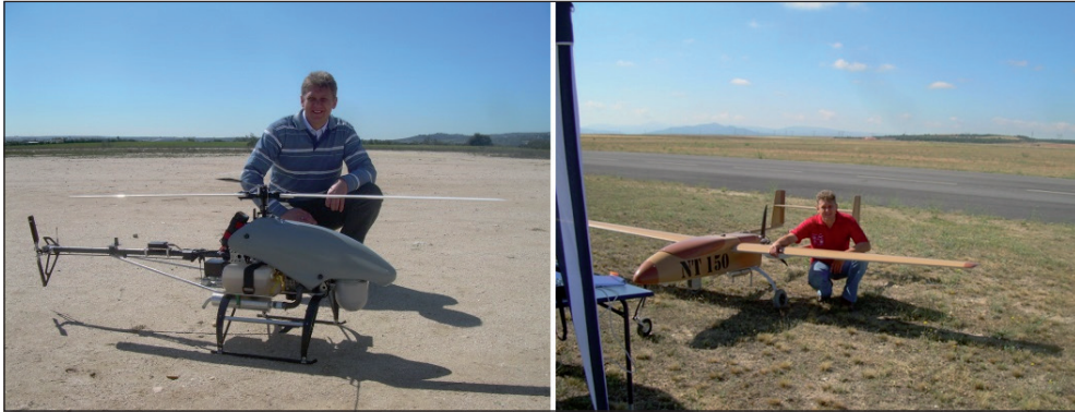
8. ábra: Nagyobb kiterjedésű ipari balesetknél történő beavatkozásra alkalmas forgó- és merevszárnyas PNR (forrás: a szerző magánarchívuma, 2009, 2010)
