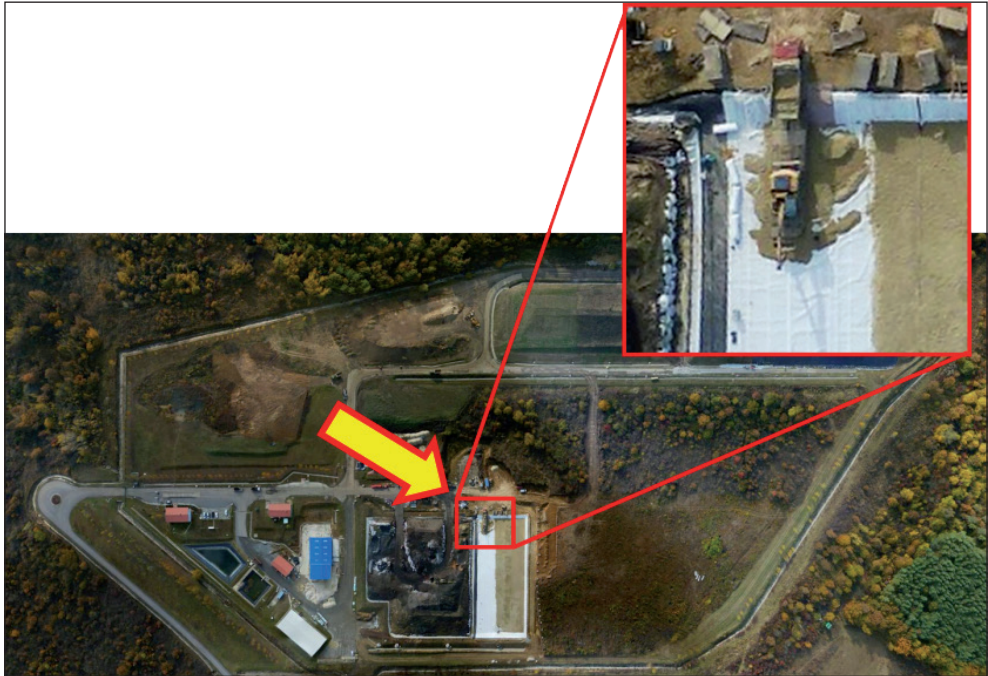
4. ábra: Új medence építési technológiájának ellenőrzése a levegőből egy ipari hulladéklerakó-telepen (forrás: a szerző magánarchívuma, 2011)
