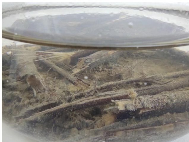
4. ábra: Aranyvessző szárral, iszappal, desztillált vízzel megtöltött Erlenmeyer lombik
