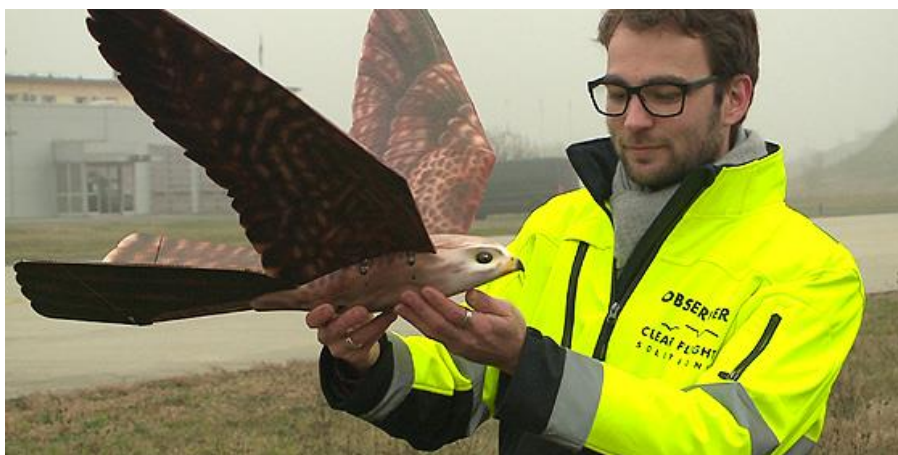
5. számú ábra. Drónsúlyom a madarak elriasztására a debreceni repülőtéren 22
