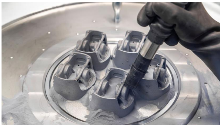
11. számú ábra. A Porsche 911 GT2 RS szelektív lézeres olvasással előállított dugattyúja 31
