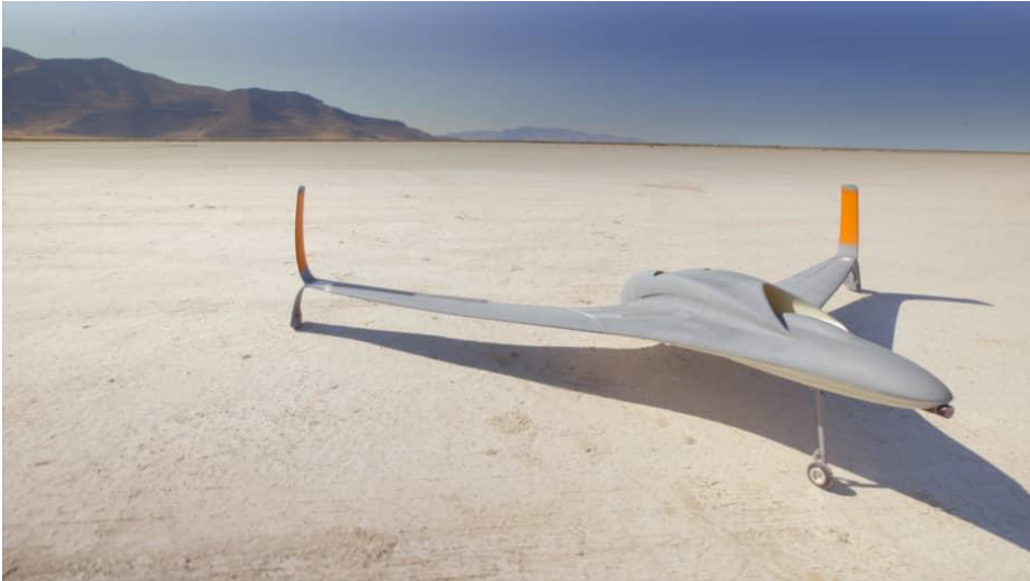
4. számú ábra. Az Aurora Flight Sciences UAV szerkezetének 80%-át 3D nyomtatással állították elő 10
