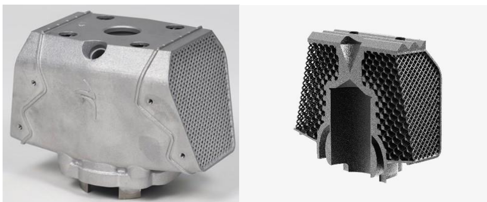
14. számú ábra. A Cobra Aero léghűtéses kétütemű UAV Otto-motorjának új geometriájú, 3D nyomtatással előállított, optimalizált hűtésű hengere 44
