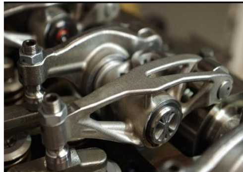
13. számú ábra. Renault DTI 5 motor eredeti szelephimbája (bal oldali kép) és a 3D nyomtatott könnyített szelephimba (jobb oldali kép) 37
