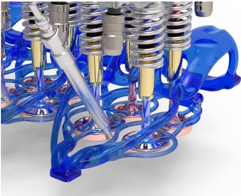
8. számú ábra. A hengerfejben lévő keresztáramú hűtőrendszer kék színnel ábrázolva 27
