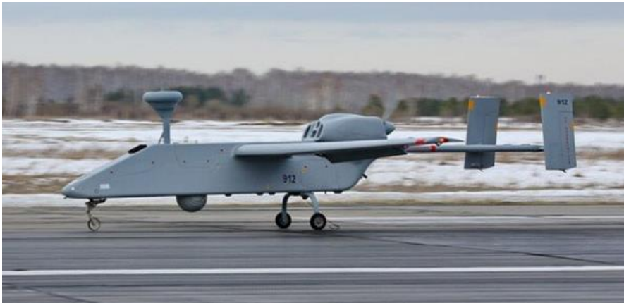
3. számú ábra. A Forpost-RU UAV-t felderítő és fegyveres változatban is üzemeltetik, utóbbinál a 85 LE-s motor 120 kg fegyverzet hordozását teszi lehetővé 8
