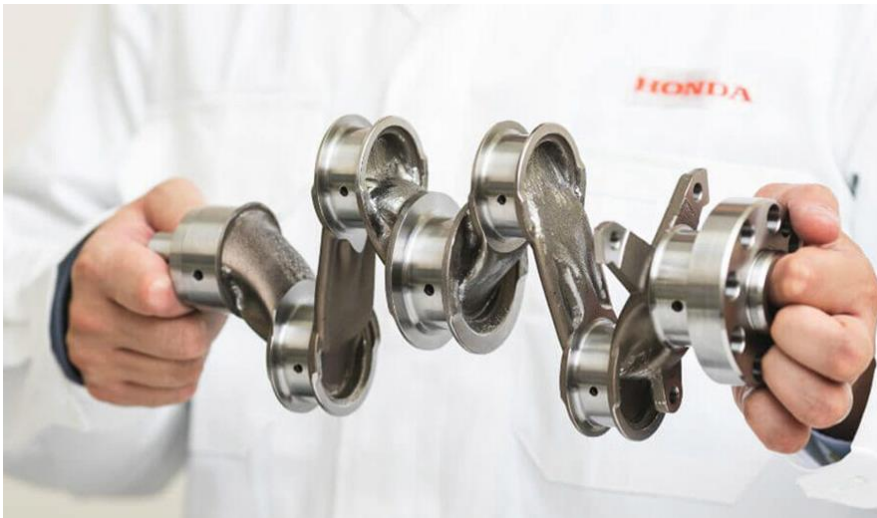
12. számú ábra. A Honda és az Autodesk közös projektjében tervezett és 3D nyomtatott forgattyústengely 34
