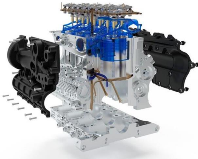
9. számú ábra. A dízelmotor, melynek hengerfejét és forgattyúházát 3D nyomtatták (kék színnel jelölve a továbbfejlesztett olajkör) 28
