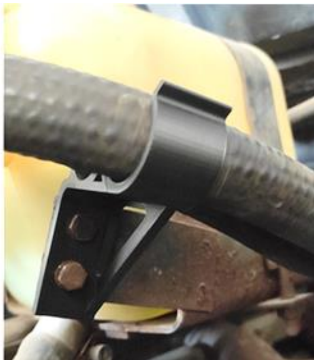
8. számú ábra. A megnövelt méretű és kikönnyített merevítéssel 1.2 pótalkatrész beszerelt állapotban 24
