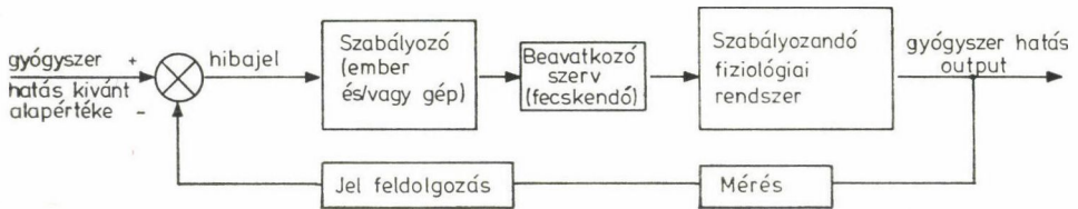
1. ábra Feed-back szabályozással működő automatikus gyógyszeradagoló rendszer általános blokkvázlata
