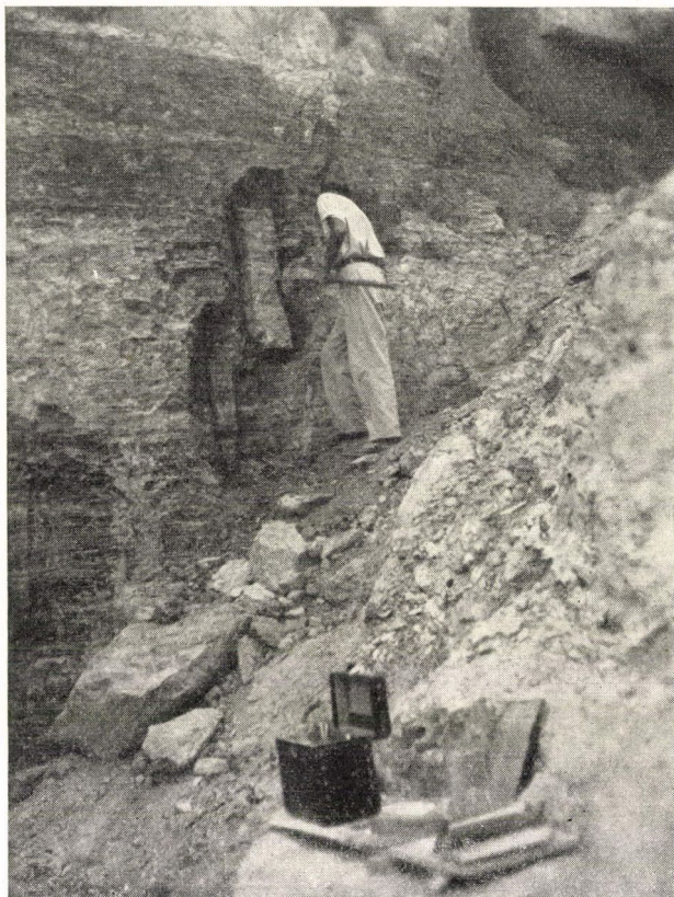
2. ábra. Balatonakarattya. A monolitok kidolgozása és pH-mérés. Előtérben a Kühn-féle reakcióméter
