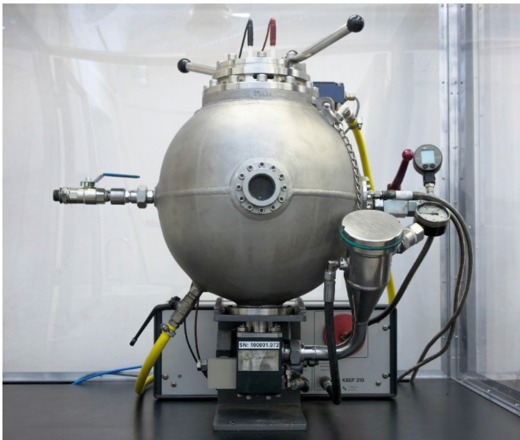
3. ábra Kühner által gyártott gömb alakú robbantókamra
