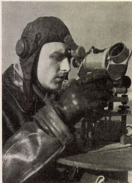
5. ábra. A szélmérő léggömb követése pilotteodolittal
