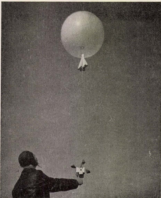
2. ábra. A magyar gyártmányú frekvencia-szonda felbocsátása. A léggömb alatt papír ejtőernyő.
