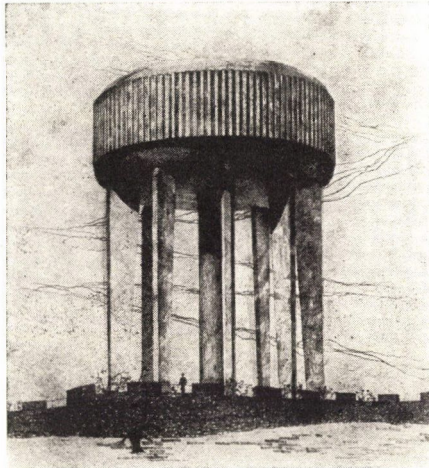
18. ábra. 800 m 3 -es egyszintű városi víztorony távlati képe
