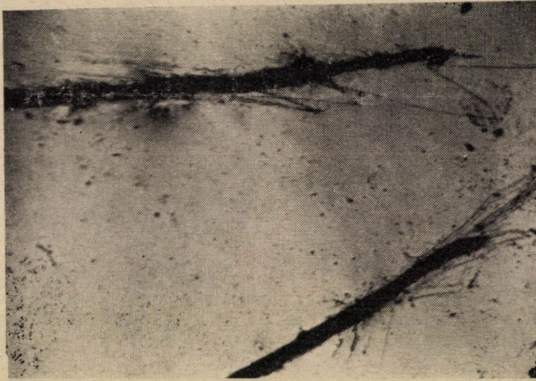
4b. ábra. Megolvadt csatornák (W-tűk között) szilícium felületén (nagyítás 100-szoros).
