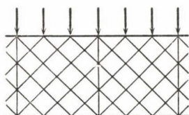
9. ábra. Többszörös rácsozású tartó merevítő oszlopok kal erősítve
