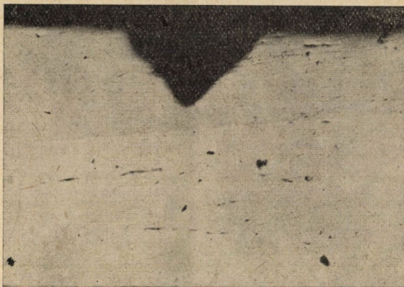
11. ábra. Kezdődő repedés mikroszkópi képe; N = 100 \times
