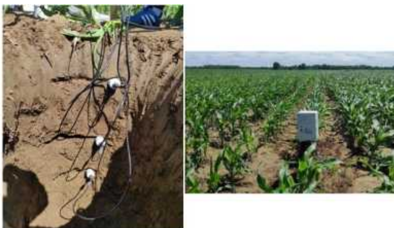
2. ábra: Talajszenzorok kihelyezése 3 mélységben
