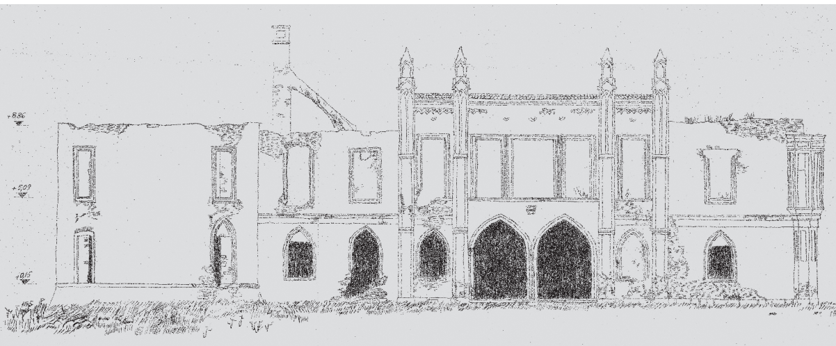
Fig. 28. Releveul fațadei neogotice și a turnului de nord-vest în 1966, Arhiva INP, Fond DMI, dosar nr. 1146.
