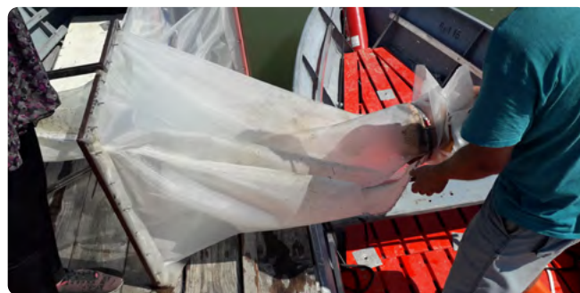
△ 3. ábra: A kiemelt mintavételi háló és az aljában összegyűlt minta
