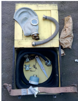
10. ábra: A magyar Medicor Művek által üzemeltetett polgári védelem számára gyártott szívó típusú friss levegős légzőkészlet az 1980-as évekből
