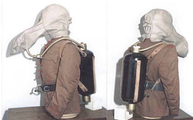
1. ábra: A Kőszeghi-féle „életmentő készülék” hordhelyzetben
