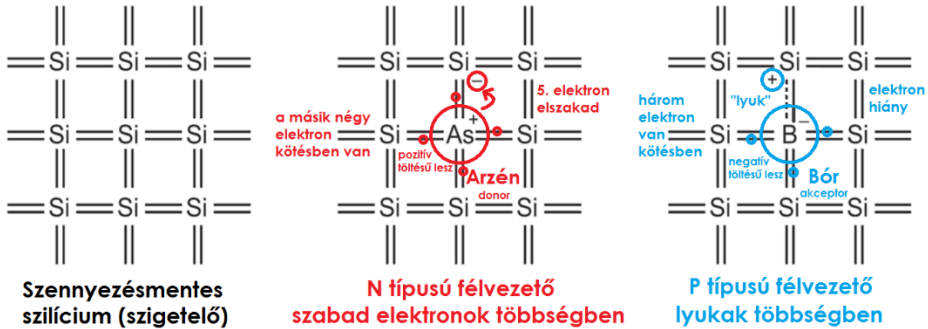
4.2. ábra. A félvezetők típusai: az N és a P félvezető alapréteg
