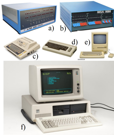
3.1. ábra. Negyedik generációs mikroszámítógépek: a) Altair, b) IMSAI, c) Atari, d) Commodore, e) Apple, f) IBM PC
