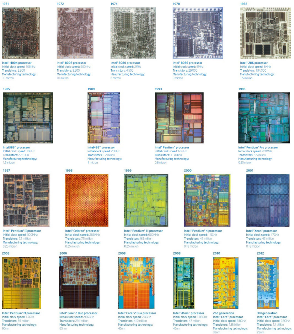
3.7. ábra. Az Intel processzor lapkájának felülnézeti képei
