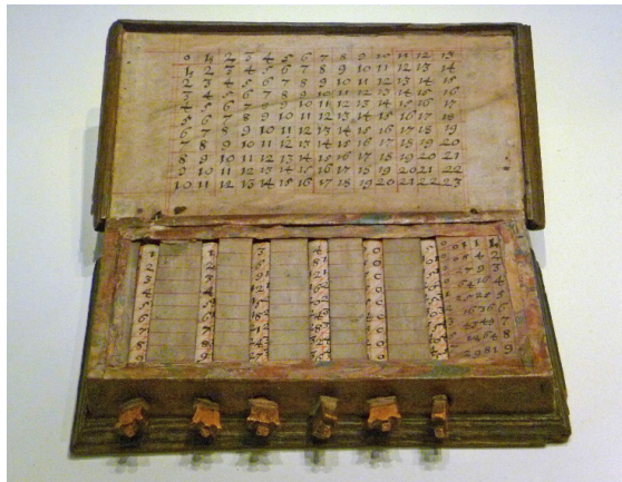
2.5. ábra. John Napier számológépe
