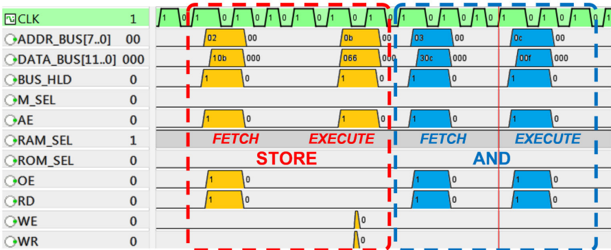
9.11. ábra. Végrehajtási ciklusok STORE és AND utasítások esetében
