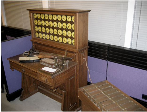
2.12. ábra. Herman Hollerith lyukkártyás tabulátora
