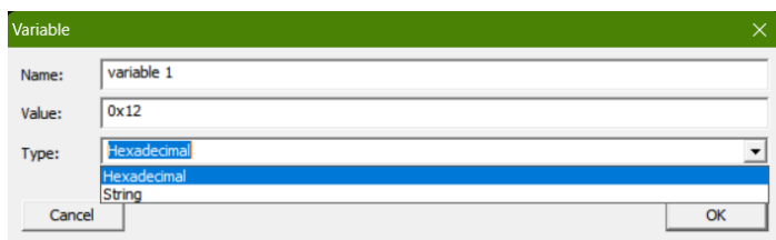
11.21. ábra. RAM címterületen elhelyezett változó létrehozása
