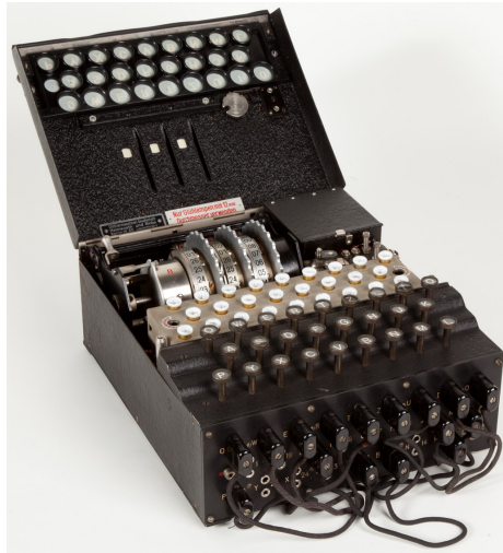
2.14. ábra. Az Enigma nevű üzenettitkosító berendezés
