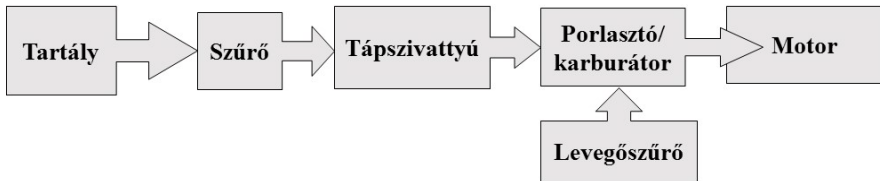
30. ábra. Az Otto-motor tüzelőanyag-ellátó rendszerének elvi felépítése
