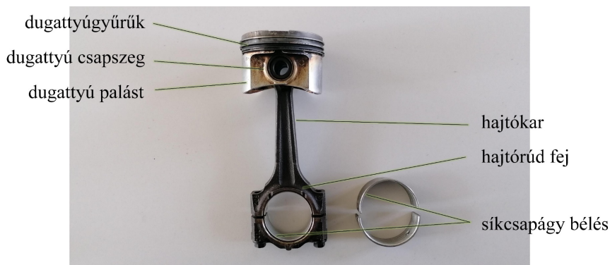
11. ábra. A dugattyú és hajtókar felépítése
