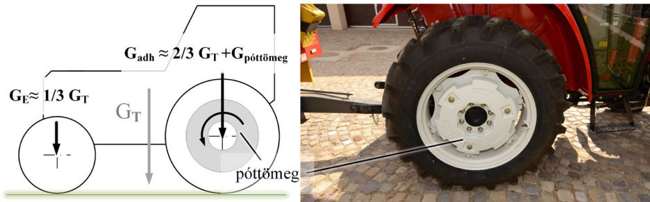
105. ábra. Adhéziós súlyerő alakulása a hátsó tengely póttömegezése esetén
