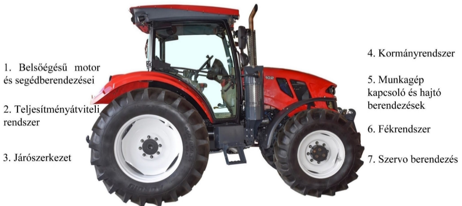
6. ábra. Az erőgép általános felépítése (IRUM, TAGRO 102)
