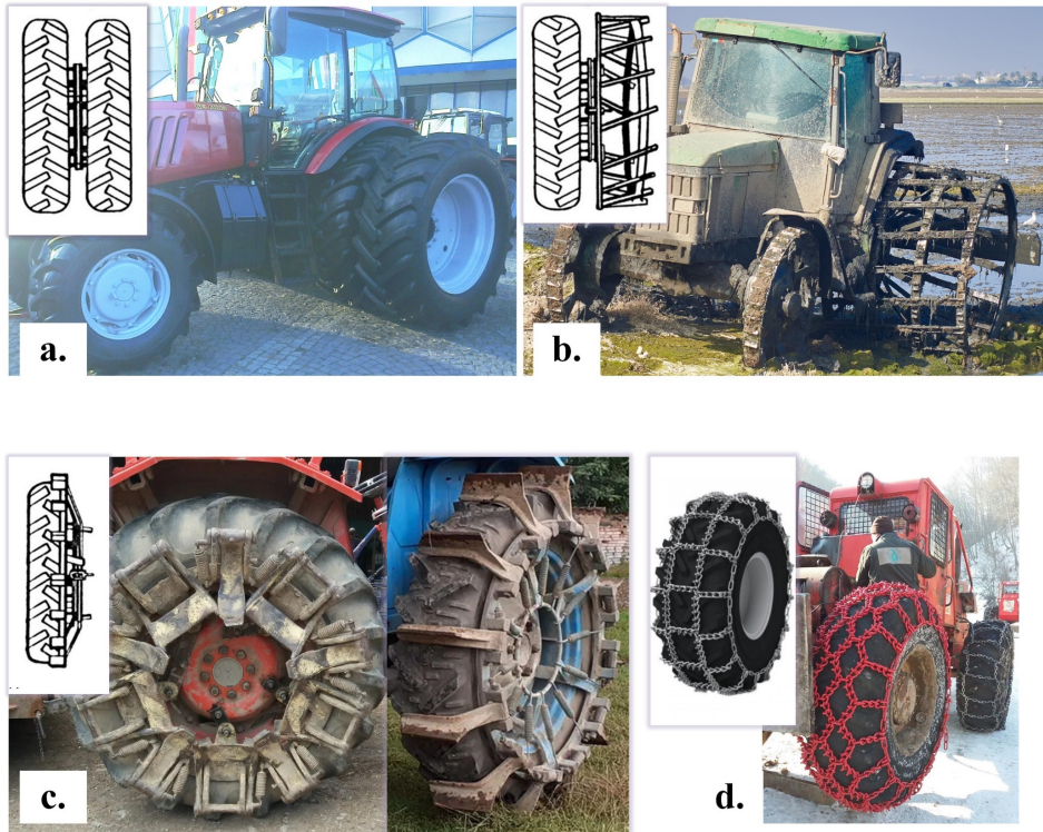
99. ábra. A kerékcúszás-csökkentés lehetőségei: a – ikerkerék, b – léces pótkerék, c – rácsos kerék, d – csúszásgátló lánc
