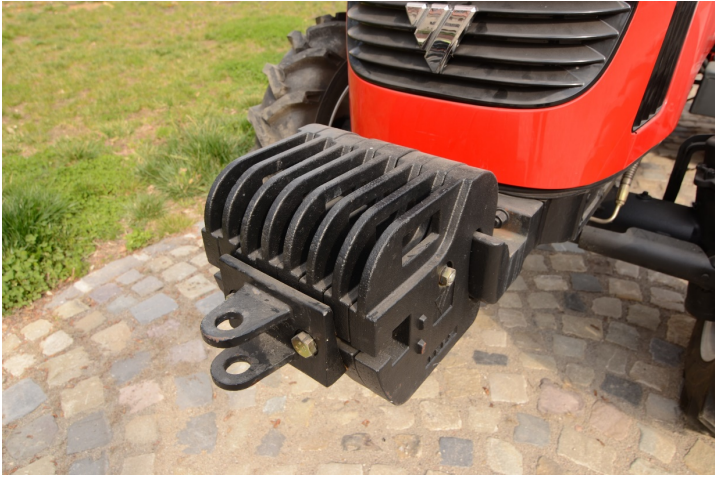
93. ábra. Póttömeg a hosszirányú stabilitás biztosítása érdekében
