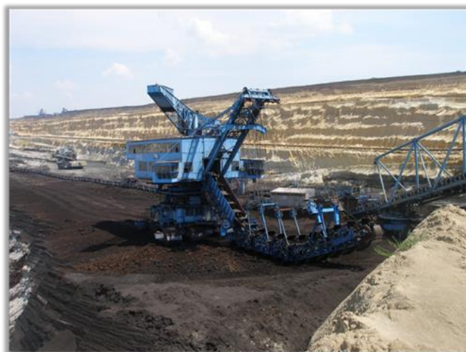
2. ábra Lignittermelés nagygéppel, háttérben a bányahomlokkal (saját fotó)
