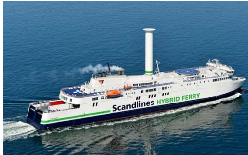
Figure 13. A rotor sail wind powers Scandlines (Werner S., Nisbet J., Hörteborn A., & Nielsen R., 2021)
