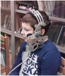
2. ábra: Az ultrahangfejet rögzítő sisak (bal oldalon, az Articulate Instruments Ltd. terméke) és az Articulate Assistant Advanced (AAA) szoftver képernyőképe (jobb oldalon) (Csapó et al. 2017a: 343, Csapó – Xu 2020: 3735)
