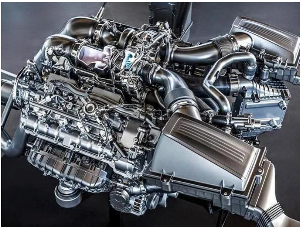
2. számú ábra. A Mercedes–AMG GT V-8 biturbó HSI motorja a hengerek közötti turbófeltöltővel 15
