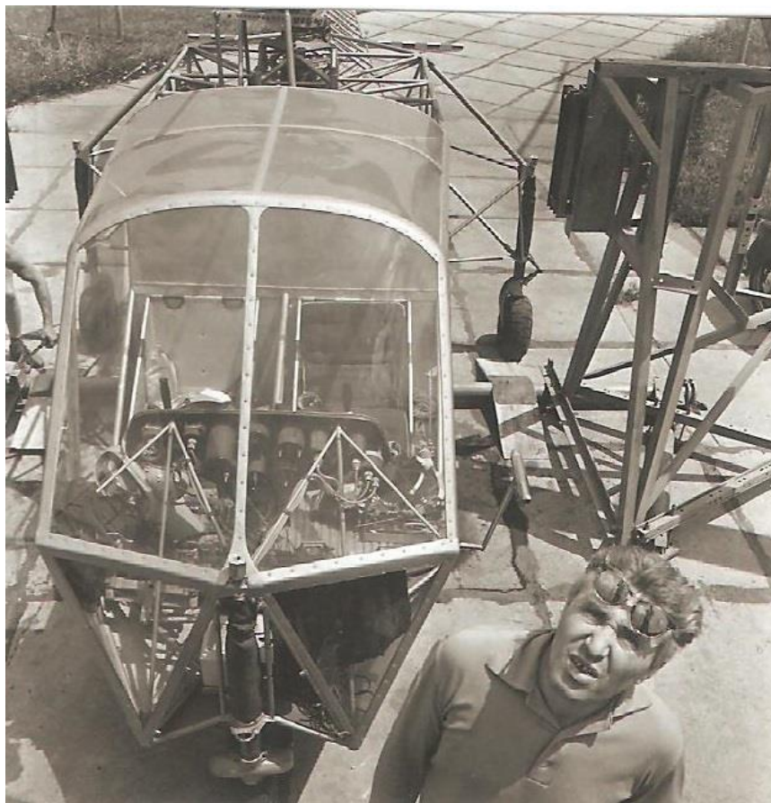
18. számú ábra. A felvételen jól látható a kísérleti helikopter kétüléses kabinja és botkormányai. Előtérben a berepülést végző Kaszás Imre helikoptervezető 86
