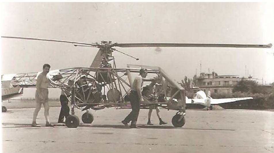
17. számú ábra. Az SOH-1 motorpróbái a Budaörsi Repülőtéren zajlottak. A képen megfigyelhető a 30^\circ -os szögben beépített csillagmotor, mellette a tüzelőanyag-tartály és fölöttük a reduktor. 83 A képen Hatházi Dániel (hátról) és Kaszás Imre (előlről) felismerhető
