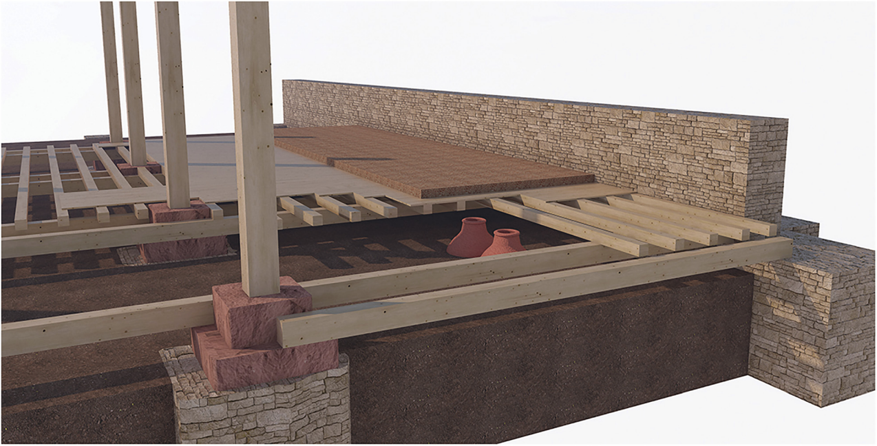
7. kép. Ságvár-Belső erőd. A horreum padlójának szerkezeti rekonstrukciója (© Mészáros Nóra)
