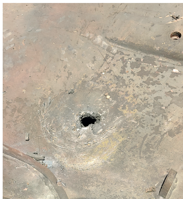
3. ÁBRA. Egy T-72-es harckocsi tornyát ért SPIKE LR2 találat (A szerző saját felvétele)
