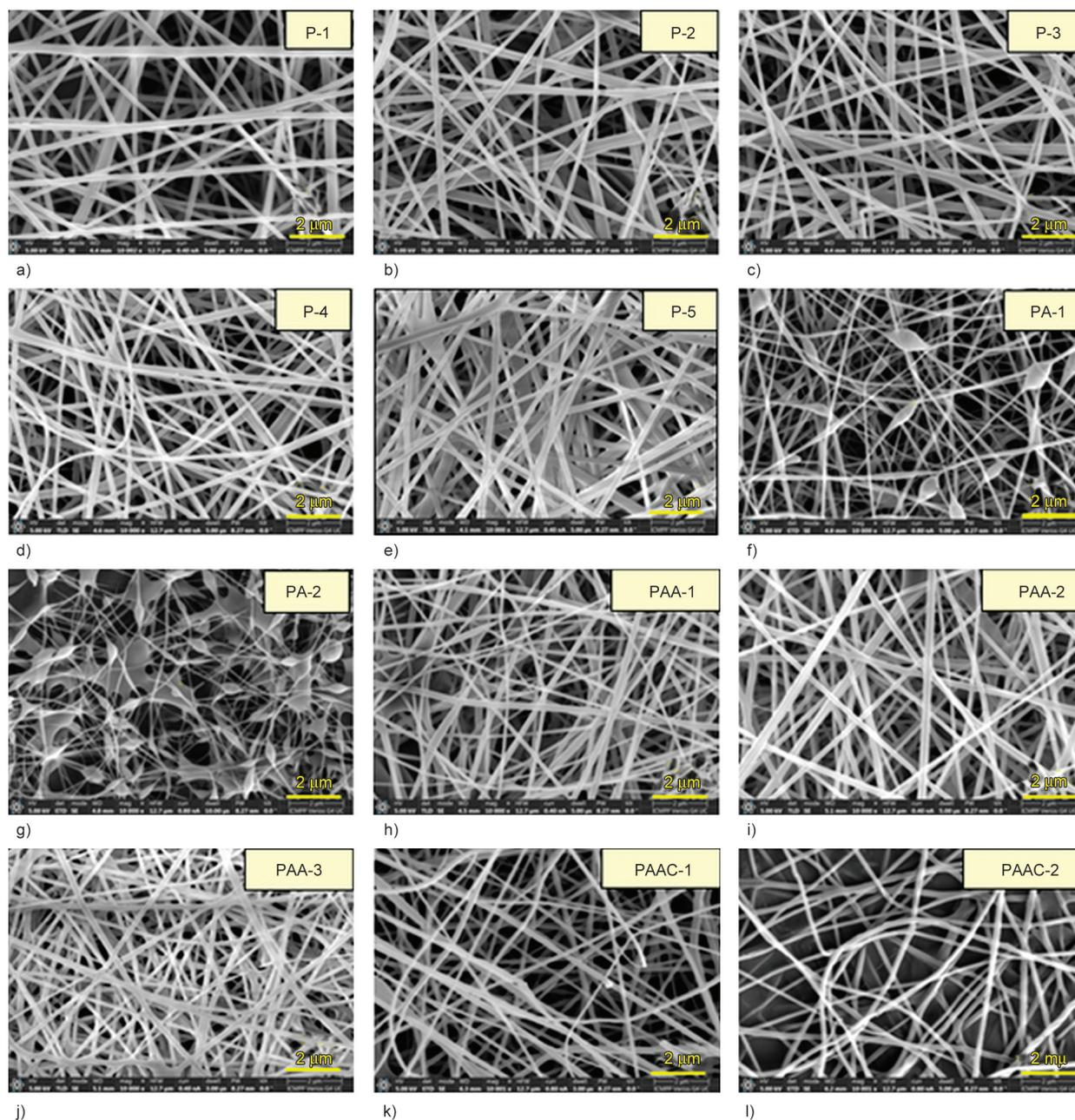
**Figure 4.** Scanning electron microscopy images of nanofibers. a) P-1, b) P-2, c) P-3, d) P-4, e) P-5, f) PA-1, g) PA-2, h) PAA-1, i) PAA-2, j) PAA3, k) PAAC-1, l) PAAC-2.
