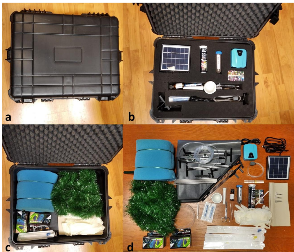
3. ábra. Téglatest alakú többfunkciós eszköz. 3/a: Légmentesen záródó láda. 3/b-d: az indukált szaporításhoz szükséges eszközök (hormonkészítmény, boncoló szett, mozsár, injekciós tű, katéter, kesztyűk, altató, törülőkendők, ivási szubsztrát stb.). Lárva neveléshez szükséges összeállítható kád, belső szűrőrendszer kisegítő elemekkel (napelemes levegőztető, nitrátmentesítő műgyanta, enzimek stb.), vízminőség ellenőrző szett, lárva neveléshez takarmányok stb.
