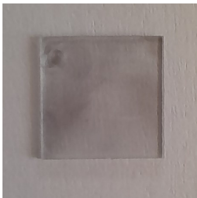
6. ábra Üveglapon immobilizált arany nanoprizmák
