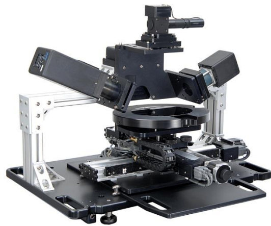
5. ábra. Az általam használt Woollam M-2000 típusú ellipszométer [8].
