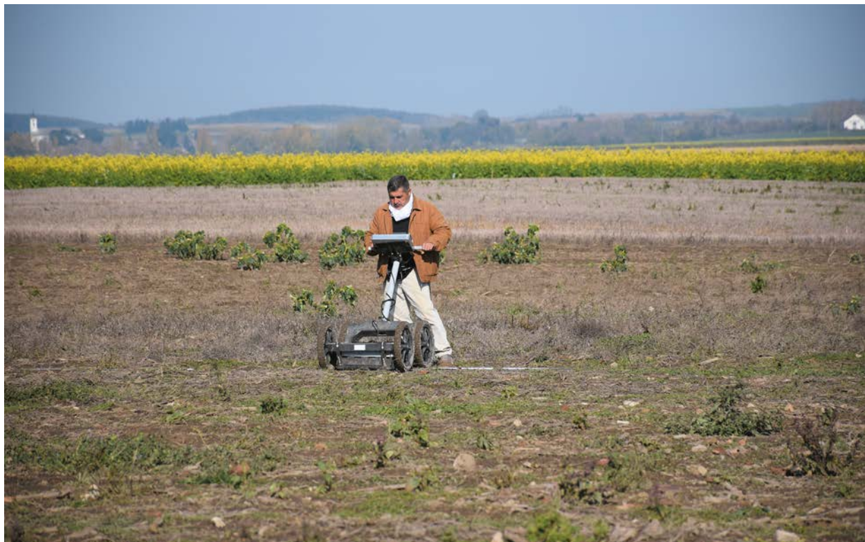
5. kép. Dalmand, Gölösi-dűlő. Talajradaros mérés 2017 őszén
