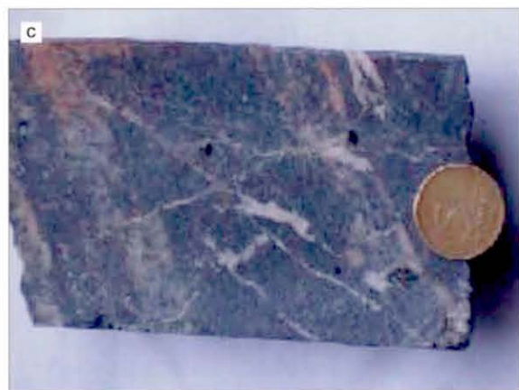
6. ábra. Posztmetamorf deformációs szerkezetek. a) Ortogneisz milonitzemcsék kataklázitban; b) az ortogneisz kataklázit makroszkópos képe; c) meredek, konjugált D3 mikrovetők; d) a repedéskitöltő szekvencia záró tagjai a barna kalcit és a ránövő laumontitkristályok
