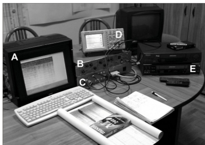
3. ábra A digitalizáló rendszer. Balra: az átjátszó összeállítása, jobbra: kapcsolási rajz
