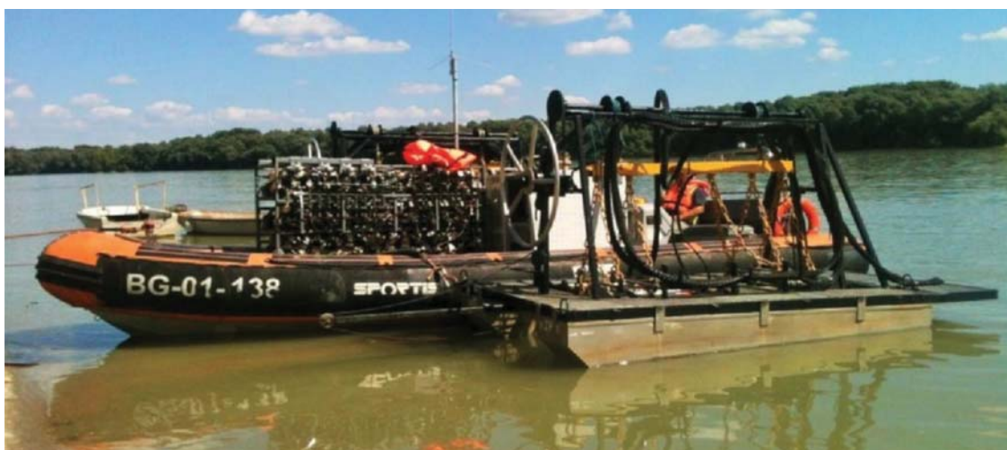
8. ábra | Air-gun forrást mozgató hajó a Dunán a két oldalán a 4-4 puskát hordozó pontonnal Figure 8 | The air-gun source carrier boat on the Danube river. 4-4 air-guns are installed at both sides of the boat
