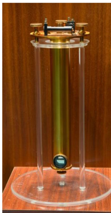
4. ábra A megépített kísérleti műszer a laboratóriumban Figure 4 Laboratory version of the gravimeter
